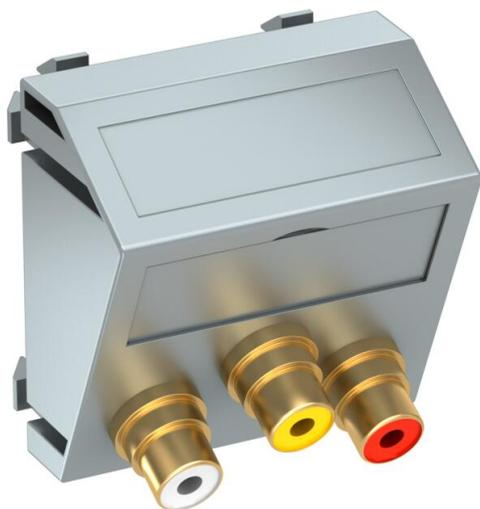
Multimediaträger mit drei Cinch Anschlussbuchsen für Audio-Video, Kabelauslass schräg, mit Beschriftungsfeld, drei Cinch Buchsen (RCA) mit Lötanschluss, Farbkodierung gelb/rot/weiß. Trägerplatte mit Rastbefestigung, geeignet für den waagerechten und senkrechten Einbau in die Systemumgebung.
