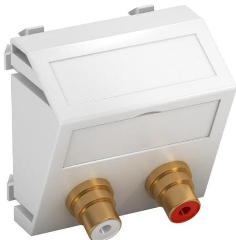
Multimediaträger mit zwei Cinch Anschlussbuchsen für Audio R / L, Kabelausschluss schräg, mit Beschriftungsfeld, zwei Cinch Buchsen (RCA) mit Lötanschluss, Farbkodierung rot / weiß. Trägerplatte mit Rastbefestigung, geeignet für den waagerechten und senkrechten Einbau in die Systemumgebung.
