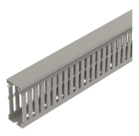
Verdrahtungskanal inkl. Oberteil und Bodenlochung zur waagerechten und senkrechten Verlegung elektrischer Kabel und Leitungen im Schaltschrank. Das Ausbrechen der Stege erfolgt werkzeuglos. Sonderlängen auf Anfrage. Geprüft nach DIN EN 50085-2-3. Unter- und Oberteil im Set.
