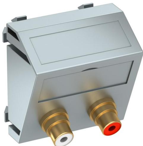
Multimediaträger mit zwei Cinch Anschlussbuchsen für Audio R / L, Kabelauslass schräg, mit Beschriftungsfeld, zwei Cinch Buchsen (RCA) mit Lötanschluss, Farbkodierung rot / weiß. Trägerplatte mit Rastbefestigung, geeignet für den waagerechten und senkrechten Einbau in die Systemumgebung.
