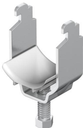
Passend zu allen C-Profileschienen mit 11 - 12 mm Schlitzweite; mindestens 6,5 mm lichter Innenhöhe und mindestens 18,5 mm lichter Innenbreite; Schelle und Schraube aus Edelstahl rostfrei, Druckwanne aus Polypropylen, halogenfrei, lichtgrau RAL 7035.
