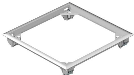
Teppichschutzrahmen zum Schutz der Teppichschnittkanten (Überdeckung 7,5 mm). Mit Spannwinkel-Befestigung für Bodenbelagstärken bis 8 mm.
