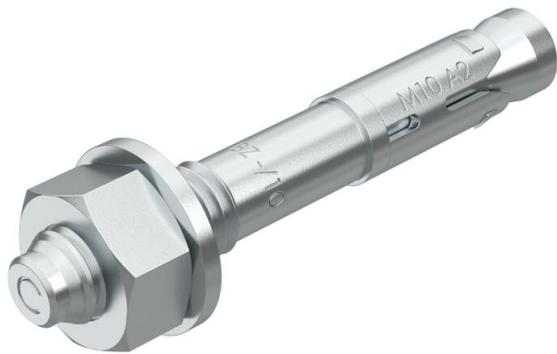
Bolzenanker BZ mit reduzierter Verankerungstiefe zur Verankerung mittelschwererer bis schwerer Lasten, sowohl im gerissenen als auch ungerissenen Beton. Er vereint hohe zulässige Lasten mit geringen Rand- und Achsenabständen. Europäisch Technische Zulassung ETA-99/0010, inklusive charakteristischer Werte unter Brandeinwirkung bis Feuerwiderstandsdauer R 120.
