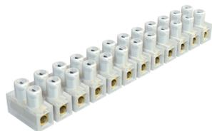
Klemmen Messing, vernickelt, Schrauben Stahl, galvanisch verzinkt und blau passiviert, 12-polige, in Einzelklemmen abtrennbare Leiste.
