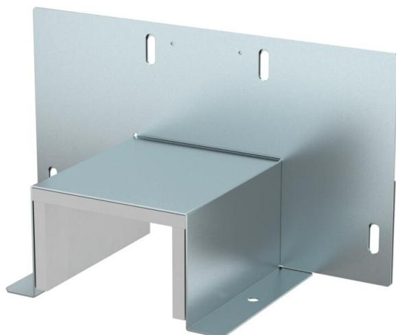
Rahmen als Zusatzisolation im Wandübergangsbereich bei direkter Wand- und Deckenmontage des BSKM 0711. Inklusive Blende und eingeklebten Dichtungen zum Abdichten der Fugen und loser Dichtung bei Kombination mit Gegenplatte, sowie Schraube für den Potentialausgleich.
