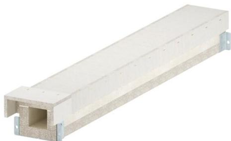
Brandschutzkanal aus wasser- und frostbeständigen Glasfaserleichtbeton der Baustoffklasse A1 gemäß EN 13501-1 zur brandsicheren Verlegung von Kabeln in Flucht- und Rettungswegen und zum Funktionserhalt sicherheitsrelevanter Anlagen. Klassifizierung I90 als I-Kanal gemäß DIN 4102 Teil 11 und Klassifizierung E30 als E-Kanal gemäß DIN 4102 Teil 12.
