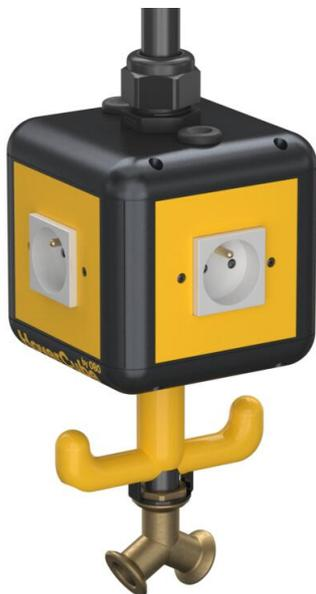
Gehäuse bestückt und vorverdrahtet, mit 1 m Rohr 1/2" und Anschluss für Druckluftschlauch 13 x 3,5 mm und 2-Wege-Verteiler 1/2", mit Aufhängeöse, Griffhaken und 4 Abdeckplatten. Bestückt wie folgt: 4 x 1fach-Steckdosen mit Erdungstift 16 A/250 V mit erhöhtem Berührungsschutz, auf zwei Wechselstromkreise vorverdrahtet, Anschluss über 2 x Klemmen 3-polig, mit Trennwand zur Stromkreistrengung.
