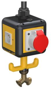
Gehäuse bestückt und vorverdrahtet, mit 1 m Rohr 1/2" und Anschluss für Druckluftschlauch 13 x 3,5 mm und 2-Wege-Verteiler 1/2", mit Aufhängeöse, Griffhaken und 4 Abdeckplatten. Bestückt wie folgt: 3 x 1fach-Steckdosen mit Erdungsstift 16 A/250 V mit erhöhtem Berührungsschutz, auf einen Wechselstromkreis vorverdrahtet, Anschluss über 1 x Klemme 3-polig, 1 x CEE-Steckdose 16 A/415 V, mit Trennwand zur Stromkreistrennung.
