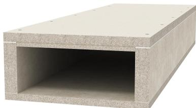
Brandschutzkanal aus wasser- und frostbeständigen Glasfaserleichtbeton der Baustoffklasse A1 gemäß EN 13501-1 zur brandsicheren Verlegung von Kabeln in Flucht- und Rettungswegen und zum Funktionserhalt sicherheitsrelevanter Anlagen. Klassifizierung I90 als I-Kanal gemäß DIN 4102 Teil 11 und Klassifizierung E30 als E-Kanal gemäß DIN 4102 Teil 12.
