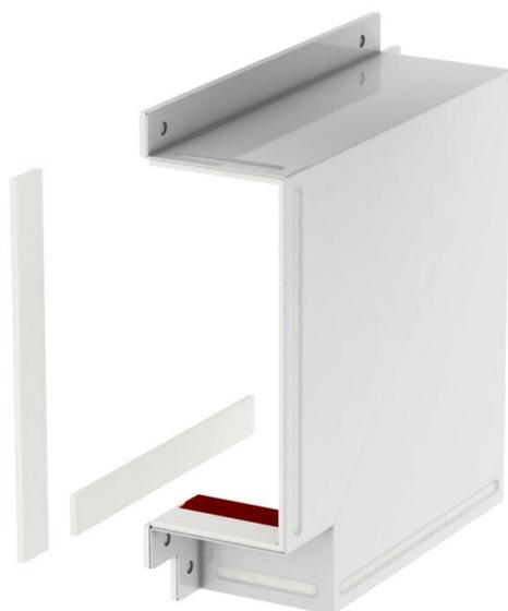
Formteil-Haube zur Abdeckung von zwei Kanälen BSKM 1025 als Flachwinkel bei direkter Wand- und Deckenmontage. Inklusive eingeklebter Dichtungen zum Abdichten der Fugen und losen Dichtungen bei Kombination mit Gegenplatte, sowie Schrauben für den Potentialausgleich.
