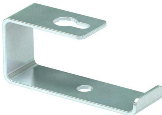
Trennbügel als Installationshilfe bei Deckenmontage des Brandschutzkanals PY-ROLINE® Con D BSK, Typ BSK 091016 und Typ BSK 121016. Montage des Bügels direkt an den Befestigungsdübeln des Brandschutzkanals.
