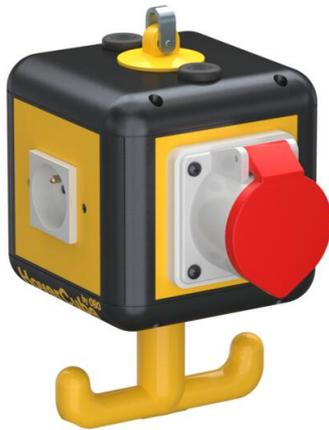
Gehäuse bestückt und vorverdrahtet mit Aufhängeöse, Griffhaken und 4 Abdeckplatten. Bestückt wie folgt: 3 x 1fach-Steckdosen mit Erdungsstift 16 A/250 V mit erhöhtem Berührungsschutz, auf einen Wechselstromkreis vorverdrahtet, Anschluss über 1 x Klemme 3-polig, 1 x CEE-Steckdose 16 A/415 V, mit Trennwand zur Stromkreistrengung.
