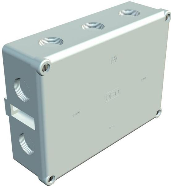
Schutzart IP54, Nennspannung 660 V, Nennquerschnitt 16 ÷ mm<sup>2</sup>, 2 Befestigungslöcher für Schrauben bis 6 mm Ø an der Außenseite des Kastens. 4 Deckelschrauben, 10 ausbrechbare Einführungen mit Gewinde M25 x 1,5. Lichte Innenmaße: 178x126x57 mm
