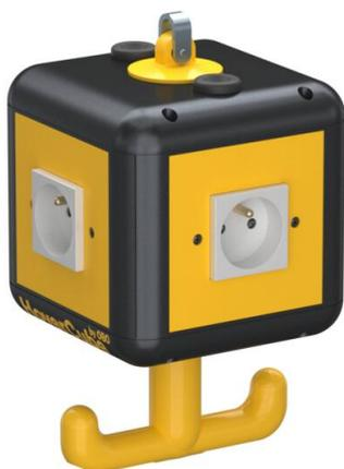
Gehäuse bestückt und vorverdrahtet mit Aufhängeöse, Griffhaken und 4 Abdeckplatten. Bestückt wie folgt: 4 x 1fach-Steckdosen mit Erdungstift 16 A/250 V mit erhöhtem Berührungsschutz, auf zwei Wechselstromkreise vorverdrahtet, Anschluss über 2 x Klemmen 3-polig, mit Trennwand zur Stromkreistrengung.
