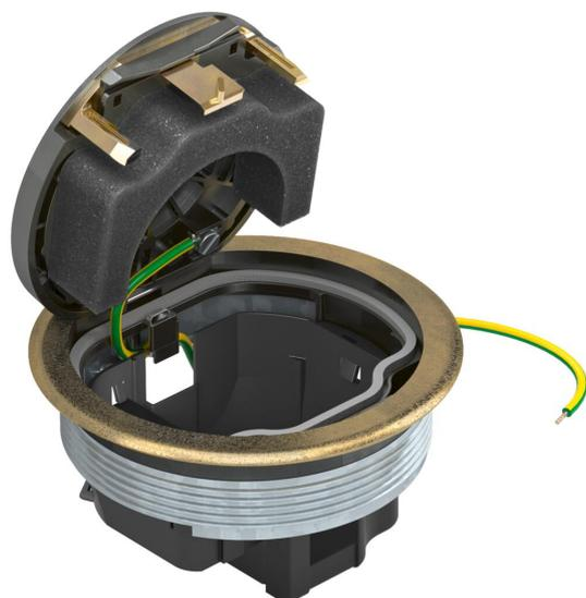
Runde Einbaueinheit mit Bodenbelagschutzrahmen zum direkten Einbau in die Anschlussdose UDL2-120. Im geschlossenen Zustand kann die Einbaueinheit nass gepflegt werden. Die Mindesteinbautiefe beträgt 70 mm. Abdeckplatte und Steckdose der Serie Modul45 sind separat zu bestellen.
