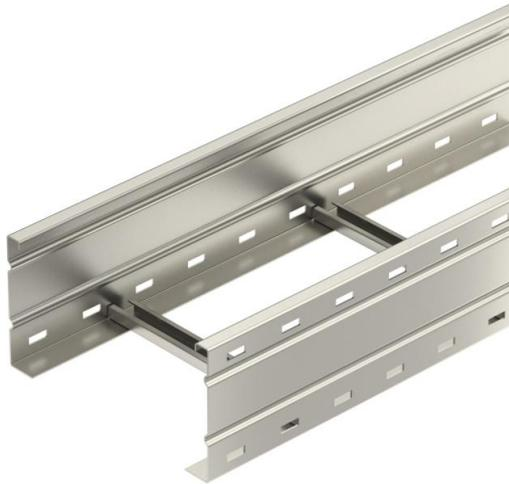
Weitspann-Kabelleiter mit gelochtem Seitenholm in 160 mm Seitenhöhe. Befestigung von Kabeln und Leitungen mit Bügelschelle Typ 2056. Längsverbinder Typ WRV 160 sind anteilig separat zu bestellen. Magnetische Schirmdämpfung ohne Deckel 10 dB, mit Deckel 15 dB.
