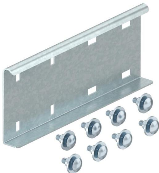
Dehnungsverbinder zum Ausgleich von thermisch bedingter Längenausdehnung. Die Anzugmomente der selbstsichernden Schrauben auf der Loslagerseite betragen 5 Nm.
