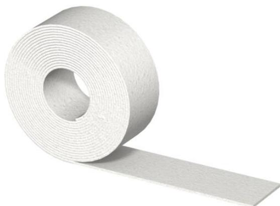
Selbstklebender Dichtungsstreifen zur Montage in den Stoßfugen der einzelnen Kanalstücke und für die Abdichtung zwischen Unterteil und Deckel der Brandschutzkanäle PYROLINE® CON D PLC EI30 - EI60 und PYROLINE® CON S PLC EI30 - EI60.
