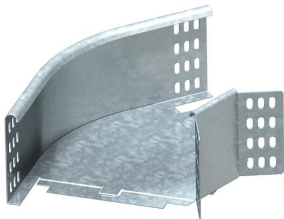
Bogen 45°, horizontal, für alle Kabelrinnentypen mit der Seitenhöhe 110 mm. Das Formteil wird in unmontiertem Zustand geliefert. Der Winkelverbinder WKV 110 ist für 90°-Bögen vorgesehen und wird vor Ort auf 45° angepasst. Inklusive anteiligem Befestigungsmaterial.
