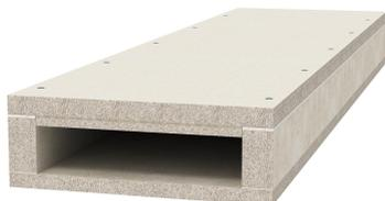
Brandschutzkanal aus wasser- und frostbeständigen Glasfaserleichtbeton der Baustoffklasse A1 gemäß EN 13501-1 zur brandsicheren Verlegung von Kabeln in Flucht- und Rettungswegen und zum Funktionserhalt sicherheitsrelevanter Anlagen. Klassifizierung I90 als I-Kanal gemäß DIN 4102 Teil 11 und Klassifizierung E30 als E-Kanal gemäß DIN 4102 Teil 12.
