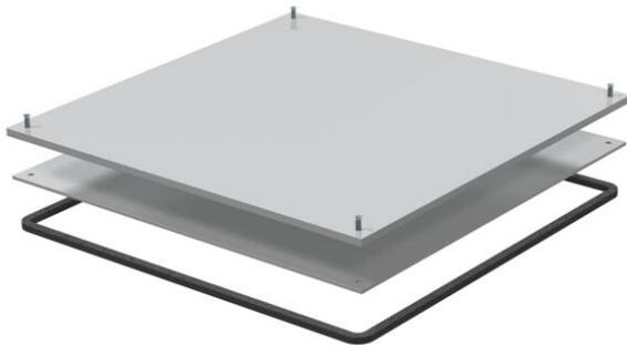
Bodenbelag-Einlegekassette für UZD350-3, zum Aufbau auf Unterflur-Zug- und -Abzweigdosen, zum Einsatz in trockenen Räumen mit trocken oder nass gepflegten Fußböden, für schnittfeste Bodenbeläge mit einer Stärke von 3 mm, bestehend aus: - Kassette mit innenliegendem Blinddeckel, - Ringdichtung zur Abdichtung und Trittschalldämmung und - V2A-Deckelbefestigungsschrauben.
