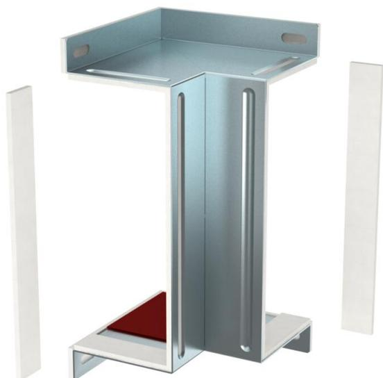
Formteil-Haube zur Abdeckung von zwei Kanälen BSKM 1025 als Inneneck bei direkter Wand- und Deckenmontage. Inklusive eingeklebter Dichtungen zum Abdichten der Fugen und losen Dichtungen bei Kombination mit Gegenplatte, sowie Schrauben für den Potentialausgleich.
