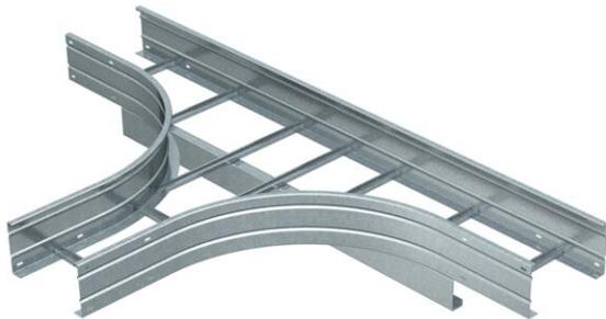
T-Stück, horizontal, für alle Weitspannkabelleitern mit der Seitenhöhe 160 mm. Zur weiteren Stabilisierung sollten im Bereich der Formteile Unterstützungen vorgesehen werden.
