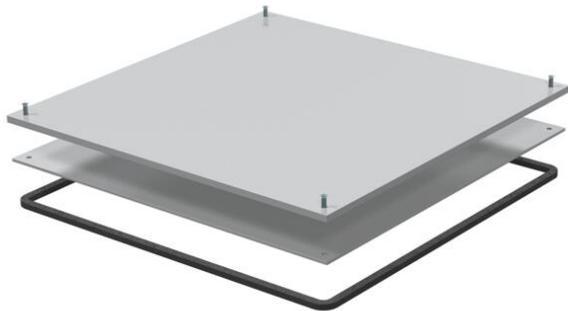
Bodenbelag-Einlegekassette für UZD350-3, zum Aufbau auf Unterflur-Zug- und -Abzweigdosen, zum Einsatz in trockenen Räumen mit trocken oder nass gepflegten Fußböden, für schnittfeste Bodenbeläge mit einer Stärke von 4 mm, bestehend aus: - Kassette mit innenliegendem Blinddeckel, - Ringdichtung zur Abdichtung und Trittschalldämmung und - V2A-Deckelbefestigungsschrauben.
