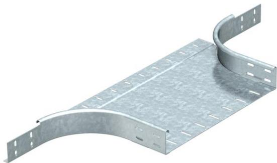
Anbau-Abzweigstück für den horizontalen und vertikalen Einsatz. Für alle Kabellinnentypen mit der Seitenhöhe 60 mm. Befestigungsmaterialien sind separat zu bestellen.
