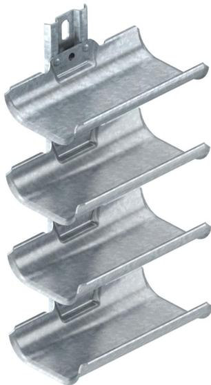
Kabeltragwannen für eine schnelle und einfache Kabelverlegung in Einsatzgebieten, in denen herkömmliche Kabeltragsysteme aus Platzgründen nicht montiert werden können. Die Kabeltragwannen verfügen über eine große Auflagefläche und abgerundete Außenkanten zum Schutz der Kabel. In Anlehnung an die DIN VDE 0298-300 sollte ein max. Stützabstand von 0,8 m nicht überschritten werden.
