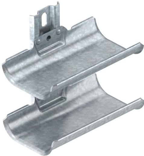
Kabeltragwannen für eine schnelle und einfache Kabelverlegung in Einsatzgebieten, in denen herkömmliche Kabeltragsysteme aus Platzgründen nicht montiert werden können. Die Kabeltragwannen verfügen über eine große Auflagefläche und abgerundete Außenkanten zum Schutz der Kabel. In Anlehnung an die DIN VDE 0298-300 sollte ein max. Stützabstand von 0,8 m nicht überschritten werden.
