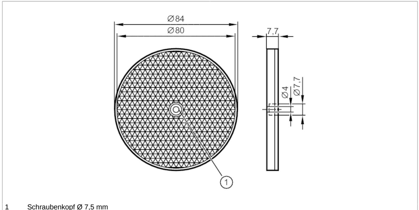
1 Schraubenkopf  $\varnothing$  7,5 mm
