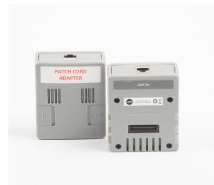
Der CAT5e-Patchkabel-Messadapter für den AEM TestPro dient zum einen dem Testen von MPTL (Modular Plug Terminated Link) Hybridstrecken aus Channel- und Permanent Link, zum anderen können mit zwei CAT5e-Patchkabel-Adaptoren Patchkabel nach ISO oder TIA-Norm gemessen werden.
