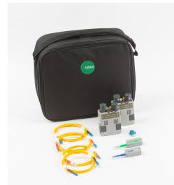
Das Singlemode-Dämpfungsmesskit für den AEM TestPro macht aus dem Gerät einen vollwertigen TIER 1 - LWL-Zertifizierer. Es bietet eine vollwertige LWL-Zertifizierung nach ISO 11801/14763-3, TIA 568.3 oder gegen Übertragungsstandards wie IEEE 802.3 oder FiberChannel. Die unterstützten Wellenlängen sind 1300 und 1500 nm.
