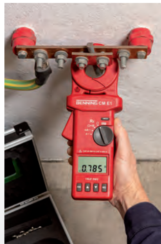
Messung des Erdschleifenwiderstandes eines Anlagenerders
