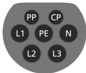
Afbeelding 2: Stekkeraansluitingen van de type 2-stekker voor de aansluiting op het oplaadstation (EVSE)
