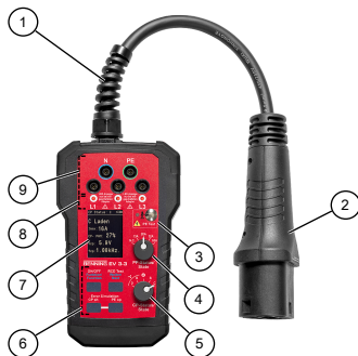
Illustration 1: Structure de l'appareil BENNING EV 3-3
