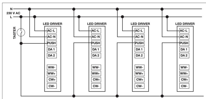
**Achtung: Bei einem Reset ist sowohl der Dimm als auch der Farbwechsel Modus durchzuführen! (Taster jeweils länger als 9 Sek. gedrückt halten)**
