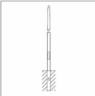
Mast, Mast, konisch rund, aus St 37-2, pulverbeschichtet, Siteco® eisenglimmer (DB 702S), Höhe: 5,0m, Zopfmaß: 76mm (Aufsatz), Erdstück: h= 800mm / Ø= 163mm, Norm: DIN EN 40, Verpackungseinheit: 1 Stück
