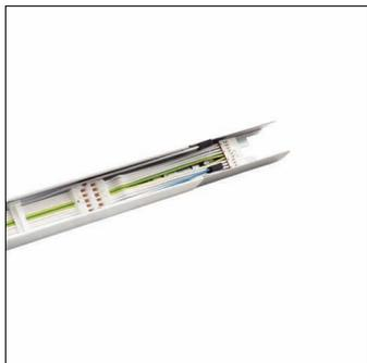
Modario®, Tragschiene, aus Stahlblech, lackiert, leuchtenweiß, 5x Systemmaß 299mm 10adrig und 1x Systemmaß 1495mm 2adrig, Länge: 1.495 mm, Breite: 58 mm, Höhe: 43mm, Durchverdrahtung: 12x 2,5mm<sup>2</sup>, mit Klemme, 10+2polig, max. 2,5mm<sup>2</sup>, Schutzart (gesamt): für Schutzart IP20/IP40, Schutzklasse (gesamt): SK I (Schutzerdung), Prüfzeichen: CE, ENEC, VDE, Norm: EN 60598, Verpackungseinheit: 1 Stück
