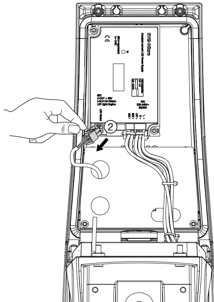
Streetlight SL 10 - Geräteträger micro / gear tray micro
