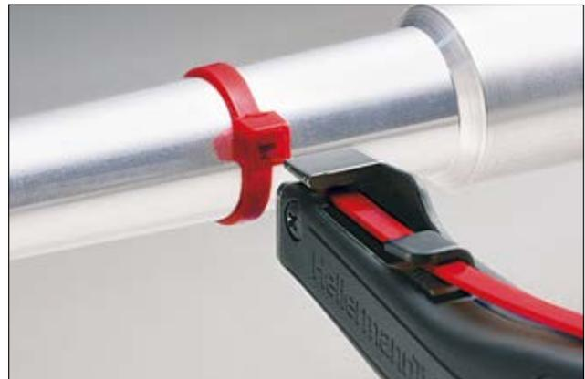
3: Schneiden (Cut): Für den Schneidevorgang ist kaum Kraftaufwand nötig. Der Anwender muss den Handhebel nur noch leicht nach hinten ziehen – rückstoßarm und ohne Vibration.
