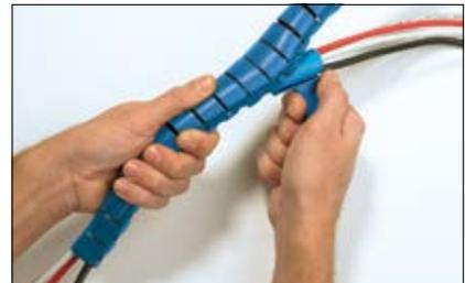
Helawrap wird nun nach dem Reißverschlussprinzip montiert.
