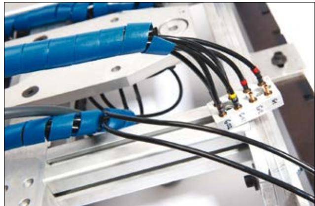
Detektierbare, metallhaltige Spiralschläuche schützen Kabel an Lebensmittelverarbeitungsmaschinen.
