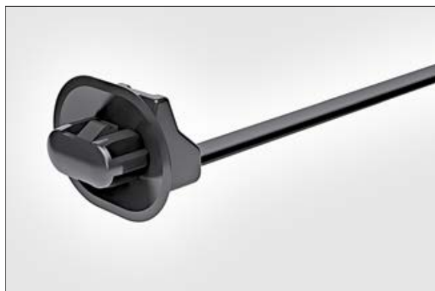
1-teiliger Befestigungsbinder T50SOSKSFT62x122PT1,7-2,3 für Ovallöcher.
