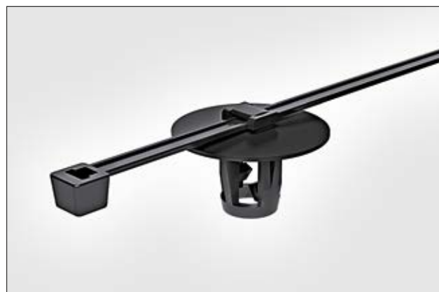
Zweiteiliger Befestigungsbinder T50RSBH5SD für Schweißbolzen.
