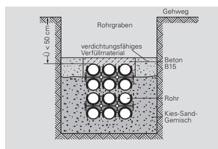
Bei Minderüberdeckung in Beton verlegte Rohrlage (Beispiel s.a. KRV A 515/A 535a/b)
