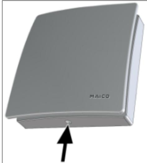
2. Pour détacher le cache de protection, déverrouiller les crochets d'arrêt avec un tournevis.
