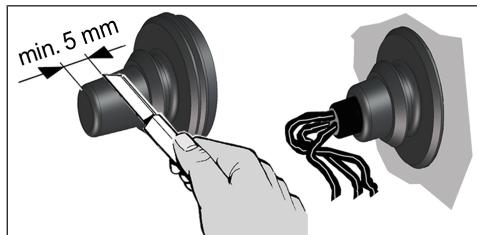
5. Leitungsstüle in Gehäuse einsetzen.
