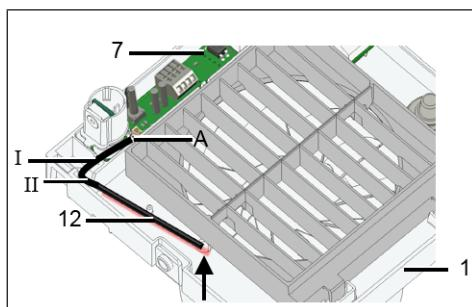
8. Placer le boîtier dans le perçage de cloison / la gaine murale et le fixer avec deux vis. Installer le boîtier sans tension ni écrasement. Utiliser du matériel de fixation de dimension suffisante.
