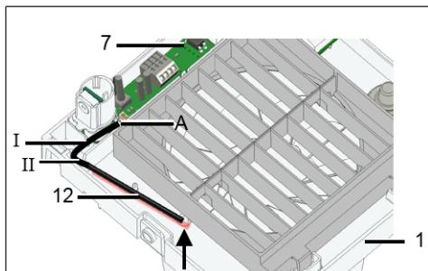
8. Gehäuse in Wanddurchbruch/Wandhülse einsetzen und mit zwei Schrauben befestigen. Gehäuse weder verspannt noch gequetscht einsetzen. Ausreichend dimensioniertes Befestigungsmaterial verwenden.
