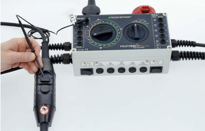
Messung des Schutzleiterstroms bei einem angeschlossenen PRCD mit dem Zangenstromwandler METRACLIP 61 als Zubehör
