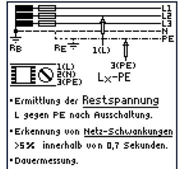
Die Messung ist ständig aktiv, d. h. Spannungseinbrüche werden automatisch – ohne Drücken einer Taste – erkannt.
