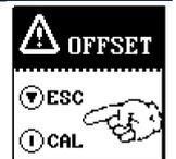
4. Starten Sie durch nochmaliges Drücken der Auslösetaste **IΔN** die Offsetmessung oder brechen Sie diese durch Drücken der Taste **ON/START** (hier = **ESC**) ab.
