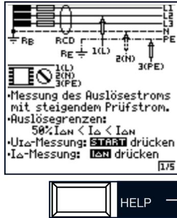
Die Messung kann durch Drücken von **ON/START** bzw. **I $\Delta$ N** oder **ESC** abgebrochen werden.
