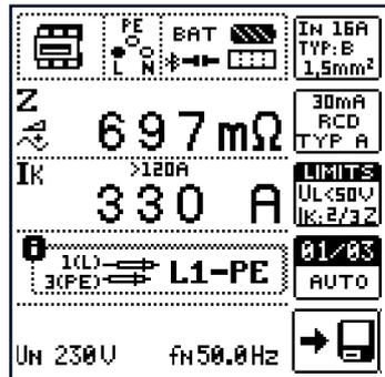
**15.5 Z<sub>LOOP</sub> Ω – MESSEN DER SCHLEIFEN-IMPEDANZ**
