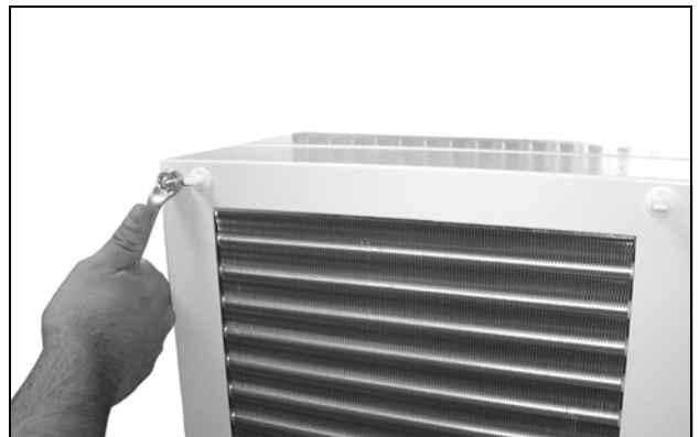
Abb. 44: Haube demontieren (vier Muttern lösen)
