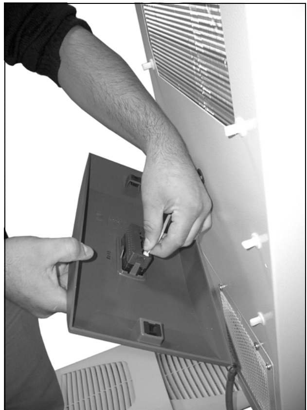
Abb. 38: Stecker vom Display abziehen (1)
