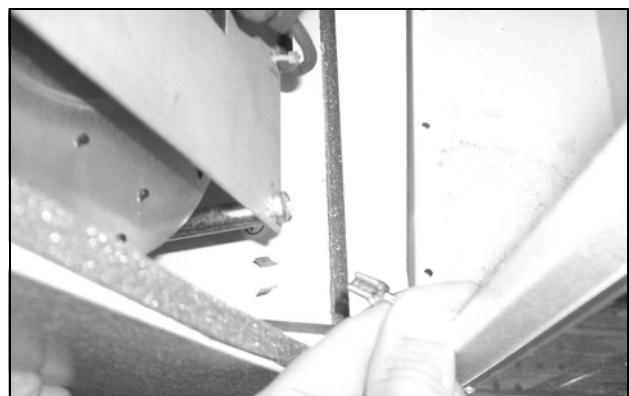
Abb. 50: Erdungskabel zwischen Haube und Chassis lösen (2)
