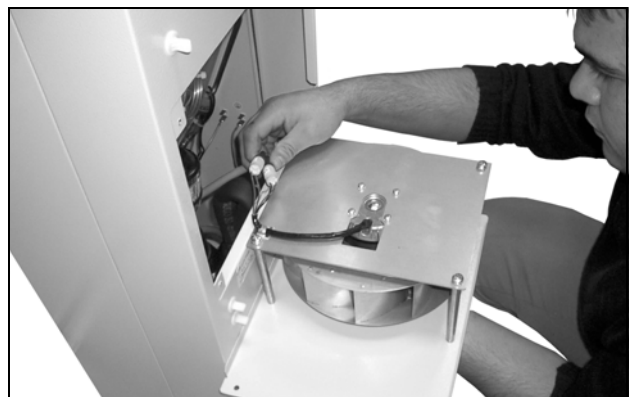
Abb. 65: Steckverbindungen des Lüfters abziehen (1)
