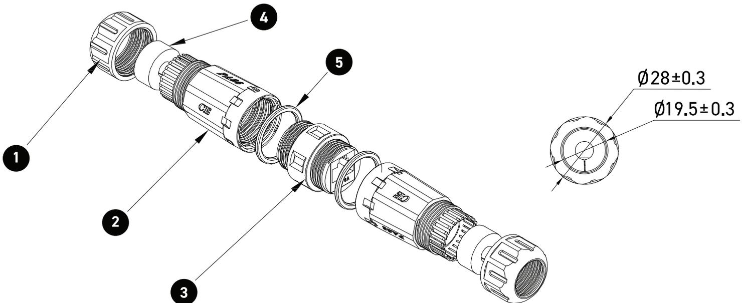
1 Hintere Abdeckung | 2 Lange Mittelabdeckung | 3 Netzmodul | 4 Gummidichtung | 5 Silikondichtung
