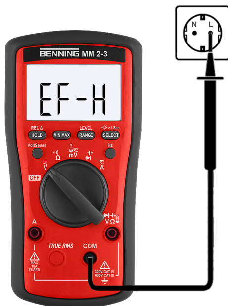
Ilustracja 15: Kontrola przewodów zewnętrznych i fazy
